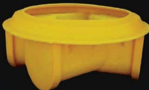
کفی منبول پلی اتیلنی به قطر ۱۲۰۰ میلیمتر به صورت چهار راهی ماهیچه دار با یک ورودی مستقیم. دو ورودی ۴۵ درجه و یک خروجی حداکثر تا سایز لوله ۴۰۰ میلیمتر. مناسب جهت منبول های ۱۲۰۰ با ریزر های ۱۰۰۰ یا منبول های به عمق کم.
