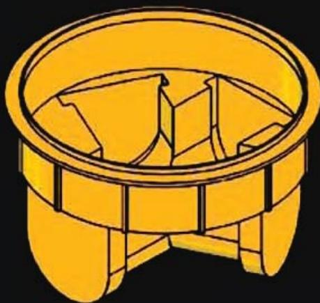
کفی منبول پلی اتیلنی به قطر ۴۰۰ میلی‌متر به صورت چهارراهی ماهیچه دار (INVERT) با یک ورودی مستقیم دو ورودی ۴۵ درجه و یک خروجی حداکثر تا سایز لوله ۴۰۰ میلی‌متر.
