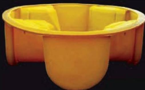
کفی منبول پلی اتیلنی به قطر ۱۲۰۰ میلی‌متر به صورت چهار راهی ماهیچه دار با یک ورودی مستقیم، دو ورودی ۹۰ درجه و یک خروجی حداکثر تا سایز لوله ۴۰۰ میلی‌متر.
