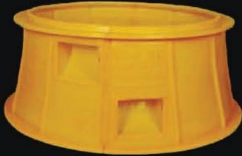
رایزر تبدیلی یا قطعه میانی تبدیلی جهت افزایش عمق منبول پلی اتیلنی قطر ۱۳۰۰ میلیمتر به میزان ۵۰ سانتیمتر و همزمان تقلیل قطر منبول از ۱۲۰۰ میلیمتر به ۱۰۰۰ میلیمتر مورد استفاده قرار می گیرد.
