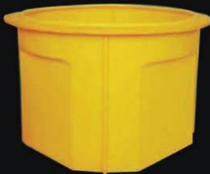
کفی منبول پلی اتیلنی به قطر ۱۰۰۰ میلیمتر به صورت چهار وجهی بدون ماهیچه (Box Type) برای سایز لوله ورودی و خروجی حد اکثر تا ۳۰۰ میلیمتر، مناسب برای شرایطی که اختلاف ارتفاع ورودی و خروجی حد اکثر تا ۲۰ سانتیمتر وجود دارد.
