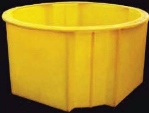
کفی منبول پلی اتیلنی به قطر ۱۲۰۰ میلی‌متر به صورت چهار وجهی بدون ماهیچه برای سایز لوله ورودی و خروجی حداکثر تا قطر ۵۰۰ میلی‌متر مناسب برای شرایطی که اختلاف ارتفاع ورودی و خروجی حداکثر تا ۴۰ سانتیمتر وجود دارد.
