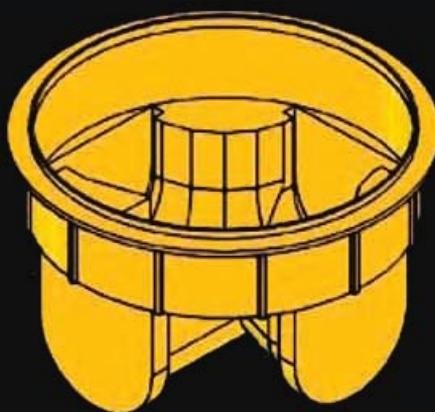
کفی منبول پلی اتیلنی به قطر ۱۰۰۰ میلیمتر به صورت چهار راهی ماهیچه دار (INVERT) با یک ورودی مستقیم، دو ورودی ۹۰ درجه و یک خروجی. حداکثر تا سایز لوله ۳۰۰ میلیمتر.
