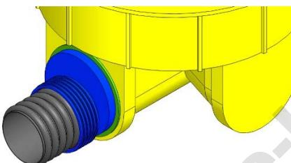
1- برای رسیدن به شرایط استاندارد در اتصال لوله دوجداره پلی اتیلن (کاروگیت) به منهول پلی اتیلن باید ابتدا محل دقیق ورودی و خروجی ها معلوم گردد و قبل از نصب منهول در جای تعیین شده ، جای ورودی و خروجی بروی بدنه منهول سوراخ گردد .
